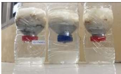
Gambar 1. Proses Filterisasi Menggunakan Cangkang Telur Dan Batu Zeolit.
